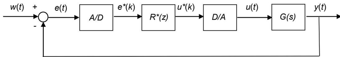
si supponga che il sistema da controllare sia descritto da  $G(s) = 8$ , il periodo di campionamento sia  $T = 0.5$ , e il regolatore digitale operi secondo il seguente algoritmo di controllo:
