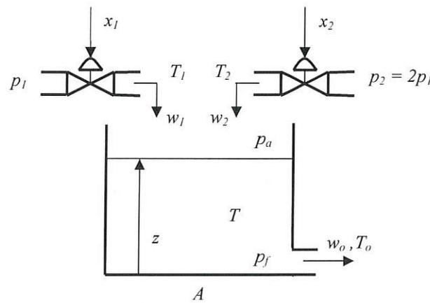
4.1) Determinare il modello dinamico nonlineare del processo, assumendo come variabile di uscita la temperatura  $T$ .
