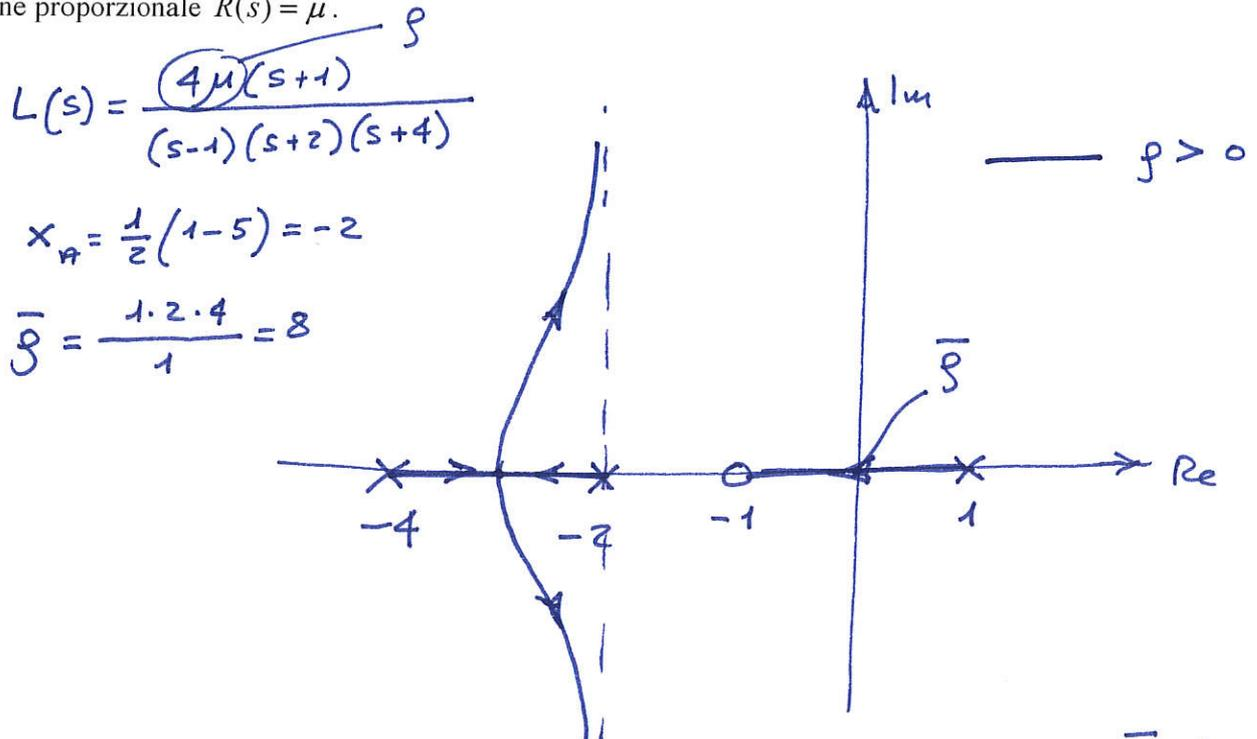
IL SISTEMA È ASINTOTICAMENTE STABILE PER  $\mu > \bar{\sigma} = 8$
