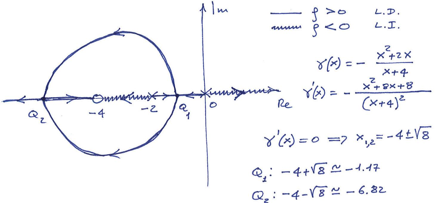
1.2) Attraverso il luogo delle radici, determinare i valori del parametro  $\rho$  per cui il sistema in anello chiuso è asintoticamente stabile e verificare il risultato attraverso il criterio di Bode.
