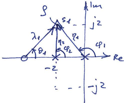
$$-\varphi_1 - \varphi_2 + \vartheta_2 = -135^\circ - 90^\circ + 45^\circ = -180^\circ$$
