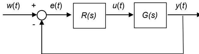
1.1) Con  $a$  generico, calcolare il baricentro (in anello aperto e in anello chiuso) e determinare il valore di  $k$  per cui il sistema in anello chiuso possiede due poli coincidenti in tale punto.
