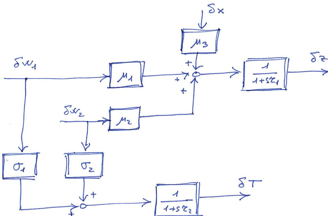
3.5) Dovendo progettare un sistema di controllo decentralizzato per il livello  $z$  e la temperatura  $T$ , e supponendo che l'ingresso  $x$  non sia manipolabile, si spieghi come si potrebbe valutare quale tra le due portate  $w_1$  o  $w_2$  sia più adatta per il controllo di temperatura.
