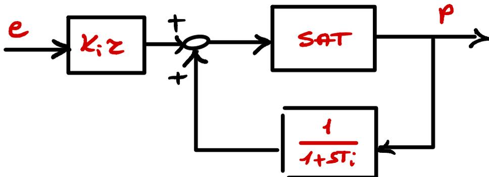
QUESTO SCHEMA CONSENTE DI LIMITARE GLI EFFETTI DELLA SATURAZIONE, EVITANDO IL FENOMENO DI INTEGRATOR WIND-UP (CARICA INTEGRALE)
