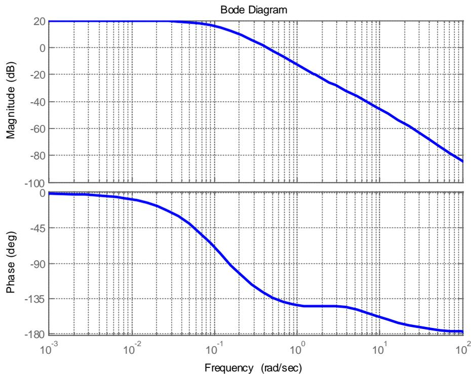
**5.1)** Dai diagrammi valutare la pulsazione critica e il margine di fase del sistema di controllo.
