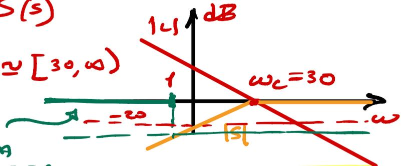
$\Rightarrow$  IL DISTURBO VIENE ATTENUATO CON FATTORE DI ATTENUAZIONE  $\approx \frac{1}{|L(j\omega)|} \leftarrow -20 \text{ dB}$
