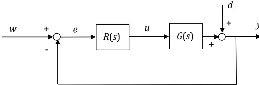
4.1) Calcolare pulsazione critica e margine di fase. Verificare inoltre che il sistema di controllo è asintoticamente stabile.
