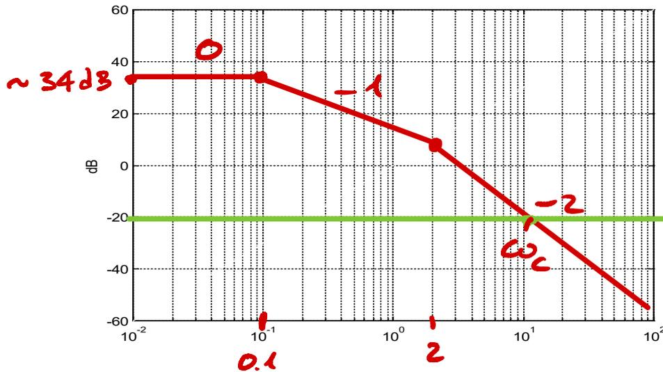
4.2) In corrispondenza dei due diversi regolatori  $R_1(s) = 10$  e  $R_2(s) = 10e^{-0.1s}$ , valutare la pulsazione critica e il margine di fase del sistema di controllo. Sulla base di tali valori, discutere la stabilità del sistema nei due casi.
