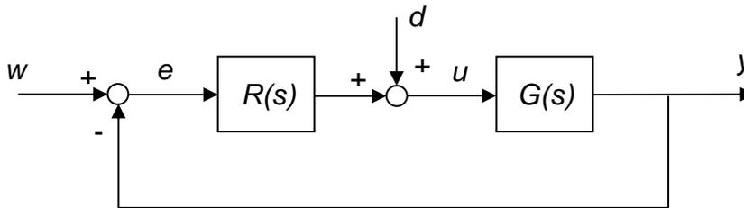
**3.1)** Tracciare il diagramma di Bode del modulo della funzione d'anello  $L(s)$ .
