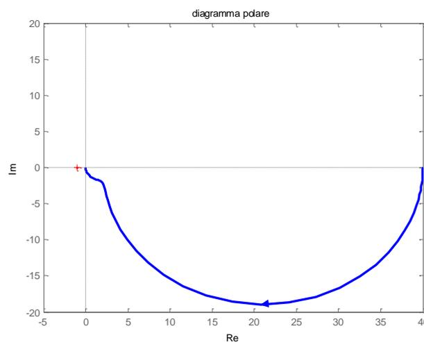
2.5) Si osservi dapprima che il diagramma di Nyquist  $\Gamma$  associato a  $G(s)$  si ottiene dal precedente diagramma polare completato con il suo simmetrico rispetto all'asse reale. Denotando con  $N$  il numero di giri di  $\Gamma$  intorno al punto  $-1/k$  e osservando che  $P = 0$ , si ricava:
