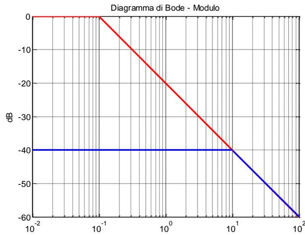
Come si nota, l'intervallo  $B = [0.2, 1]$  corrisponde a una zona in cui il diagramma di  $|M(j\omega)|$  è circa orizzontale e assume il valore  $-40$  dB. L'effetto del disturbo viene quindi amplificato di tale valore, corrispondente a un fattore di attenuazione di 0.01.
